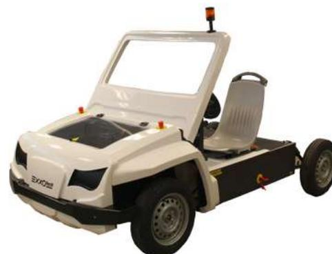
Véhicule électrique pédagogique, le HE-3000 est idéal pour l'étude d'un système de traction électrique automobile.
