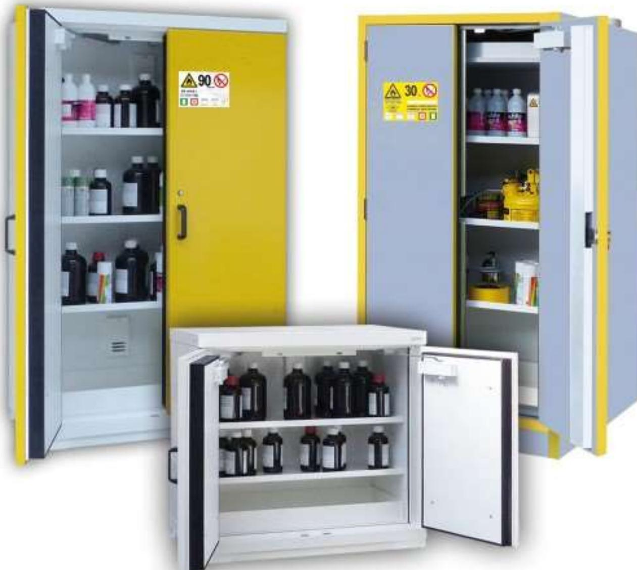
Les produits inflammables et/ou explosifs doivent être stockés dans des armoires de sécurité. Les armoires EN 14470-1 disposent d'une résistance au feu permettant de protéger les produits d'un éventuel incendie. Nous proposons des résistances au feu de 30, 60 ou 90 minutes ; les 30 et 90 minutes étant également disponibles en armoires compartimentées pour le stockage de différents types de produits chimiques.
