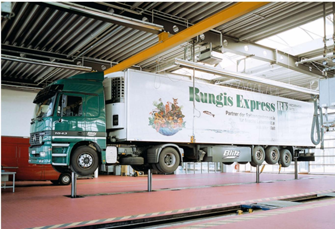
Die Lkw-Stempelhebebühnen der DUPLEX-Serie wurden unter völlig neuartigen Gesichtspunkten entwickelt. Dem Faktor Sicherheit wurde dabei besondere Aufmerksamkeit gewidmet. Die Aufgabe, die bisher von einem Zylinder bewältigt wurde, wird nun von zwei Zylindern übernommen. Der äußere Zylinder steht ausschließlich für Hebe- und Senkaufgaben zur Verfügung. Der innenliegende zweite Zylinder dient ausschließlich der Sicherheit.
